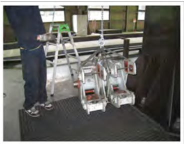
制動機オーバーホール
